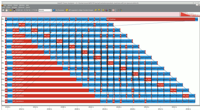
Figure 27 – Produit parallèle de matrices sur 16 processus, pour une taille de matrice de 1024 (premier algorithme)
